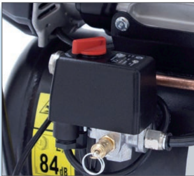
Anlaufentlastung über Condor Druckschalter
