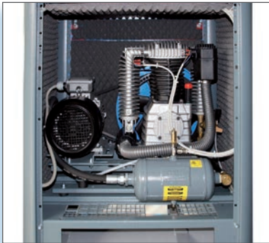
Innenansicht: Hochbelastbares Industrieaggregat mit 3 Liter Vordruckbehälter in kompakter Bauweise
