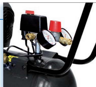
Anlaufentlastung über Condor-druckschalter
