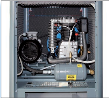
Innenansicht: Hochbelastbares Industriemagazin mit 3 Liter Vordruckbehälter in kompakter Bauweise
