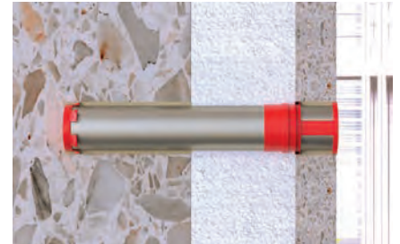
Detail: Sanierung von Wetterschalen
