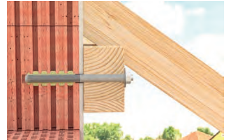
Detail: Holzkonstruktionen in Durchsteckmontage
