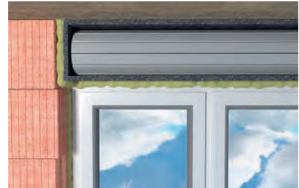
Anschlussfugen um Rolladenkästen
