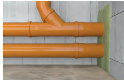
Füllen von Rohrdurchführungen
