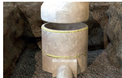
Abdichten von Beton-Schachtringen
