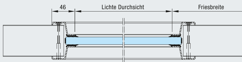
Verglasung mit aufgesetztem Stahlprofil ohne sichtbare Verschraubung auf der Bandseite für Rechteck- und Rundverglasung (Standard)
