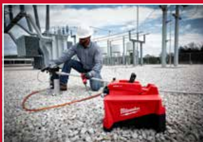
Der 1,8 m lange, kabelgebundene Controller ermöglicht dem Benutzer das Arbeiten abseits der Pumpe
