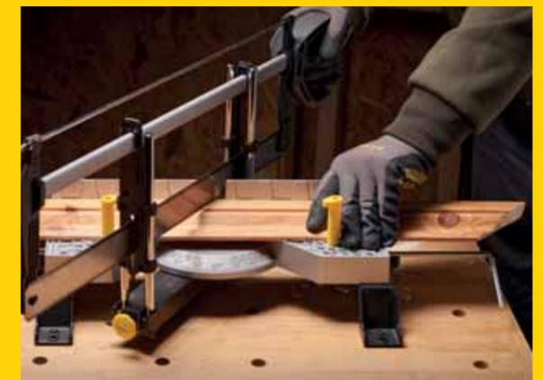
Die STANLEY® Gehrungsladen helfen zuverlässig beim Sägen und Kürzen von Profilen, Rohren oder Leisten. Die praktischen Sägehilfen ermöglichen präzise Schnitte in verschiedenen Winkeln.
