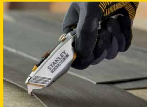
Arbeitsmesser mit einziehbarer Klinge ermöglichen das schnelle Verstauen der Klinge bei Nichtgebrauch. Abhängig vom Modell können die Klingen in bis zu 5 verschiedenen Stufen einrasten und ermöglichen dem Anwender damit das präzise Schneiden verschiedener Materialien.
