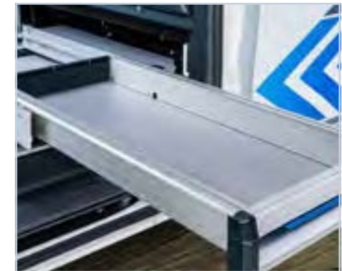
Robuste SoboGrip Mehrschichtplatte verhindert Rutschen der Ladung
